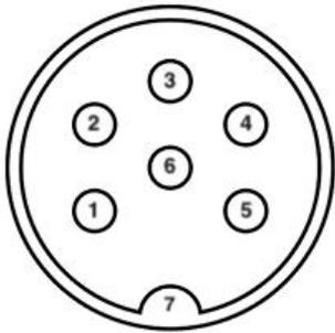
Pin 1: Externe Spannungssteuerung (5V, 10V)
